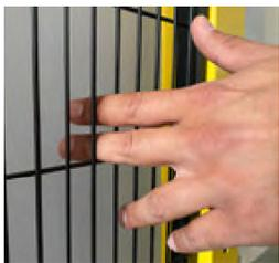
Le tableau affiche les types d'ouverture réguliers. La dimension de l'ouverture "e" correspond au côté d'une ouverture carrée, au diamètre d'une ouverture arrondie et au plus petit côté d'une ouverture en meurtrière. Pour les ouvertures supérieures à 120 mm (4 23/32"), les distances de sécurité sont conformes aux exigences énoncées dans la norme UNI EN ISO 13857 4.2.2.
