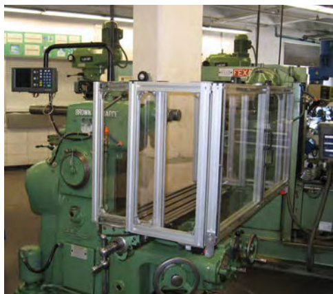
SÉCURISATION D'UNE FRAISEUSE MILLING MACHINE SAFEGUARDING
