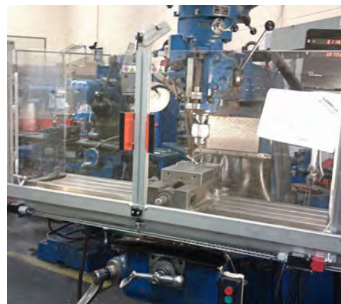
SÉCURISATION D'UNE FRAISEUSE MILLING MACHINE SAFEGUARDING
