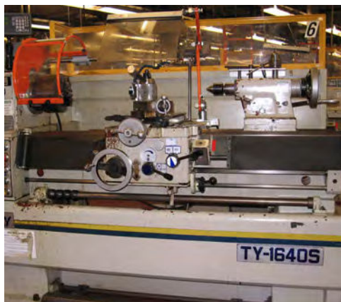
SÉCURISATION D'UN TOUR LATHE SAFEGUARDING
