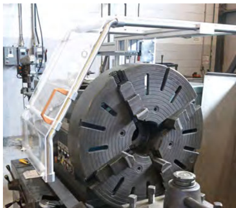
SÉCURISATION DE TOUR À MÉTAL METAL LATHE SAFEGUARDING
