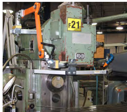
SÉCURISATION D'UNE FRAISEUSE MILLING MACHINE SAFEGUARDING
